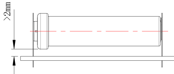
图 22 传感器与电路板焊接示意图
